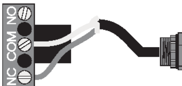
图 30 在继电器接线盒内的信号继电器接线
